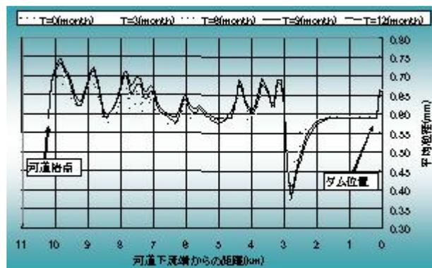
1年間の降雨によるダム堆砂の経時変化を示したものです。貯水池上流部で粒径の比較的小さい土砂が堆積している様子がわかります。
