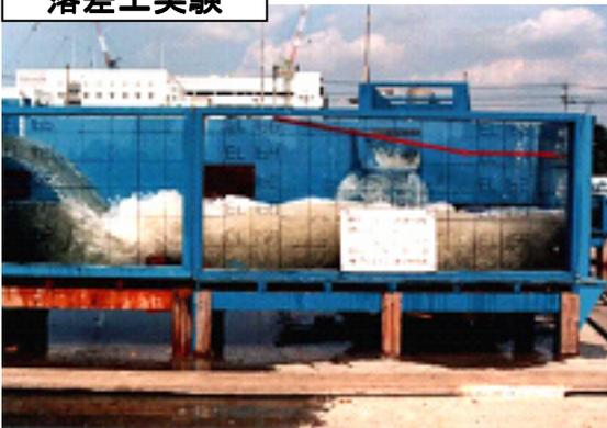
落差工は、急流河川の河床を階段状にし、水流の余剰水頭を減勢させ、下流の河床低下を防ぐことを目的とする施設です。
