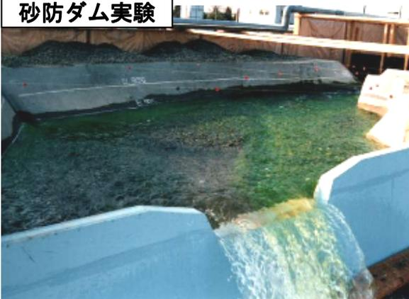
砂防ダムは、流送土砂礫の貯留や調節、渓床勾配の緩和、縦・横侵食の防止などを目的とする構造物です。
