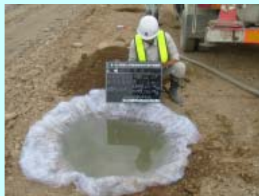
密度試験・透水試験(水置換法) (マリョットによる定水透水試験も行います)
